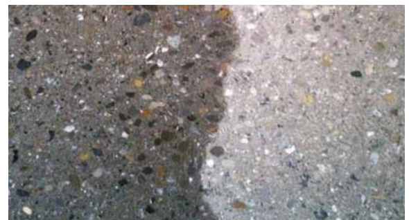
Béton humide / Béton frais
