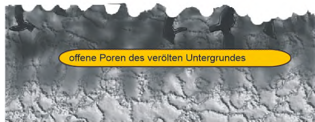
Offene Poren nach dem Kugelstrahlen
