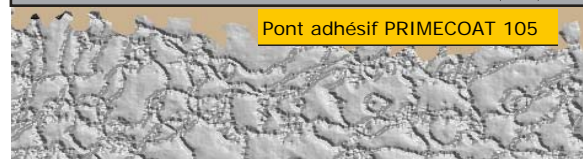
Pose de la chape dans les 15 minutes qui suivent l'application et la pénétration par massage du pont adhésif PRIMECOAT 105 dans le support.
